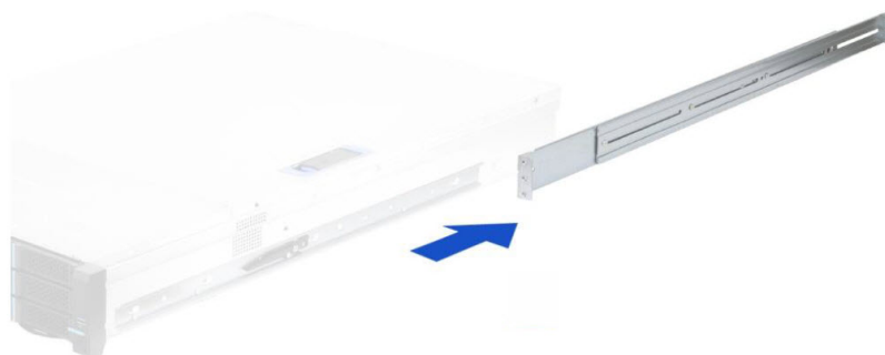
Рисунок 2.4 – Установка изделия в стойку
