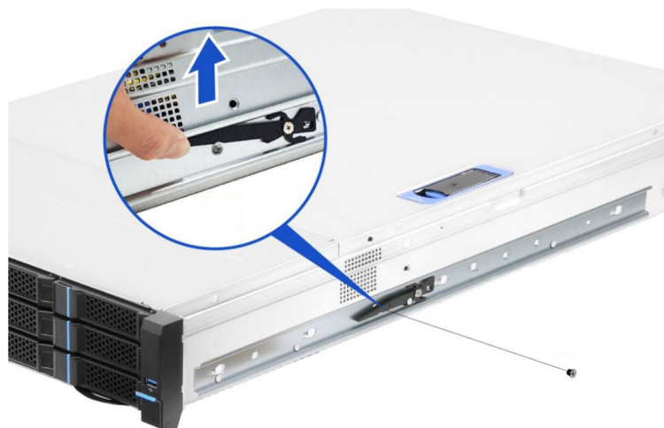
Рисунок 2.3 – Установка внутренних направляющих на изделие
