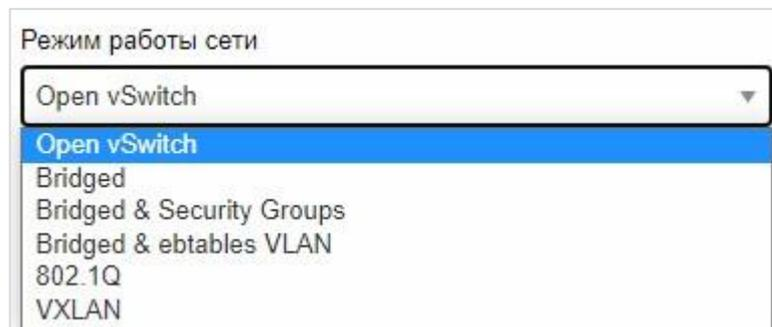
Рисунок 76 – Режимы работы виртуальной сети
